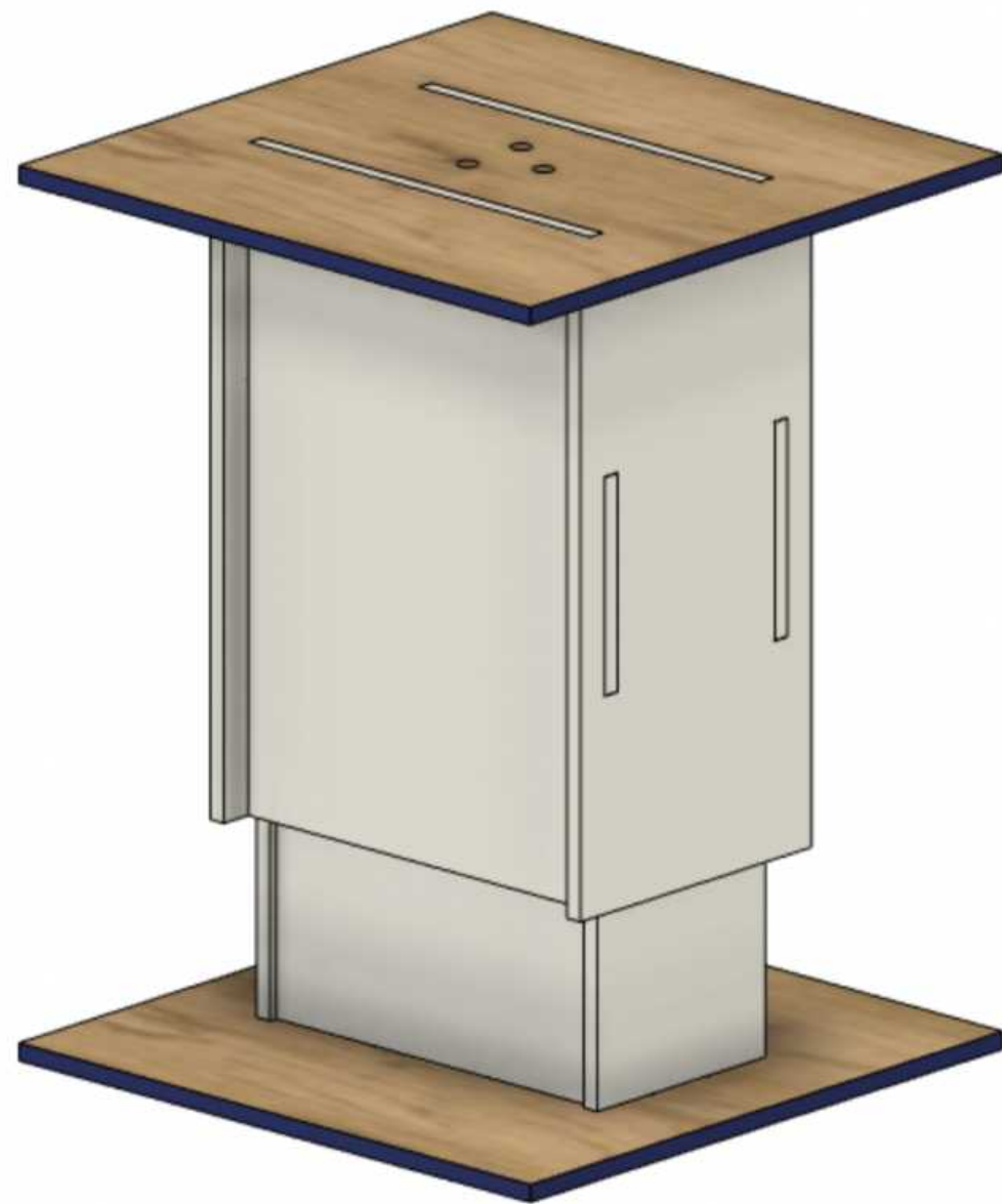
Unit a Outer Top: Edge Primer + Blue Outer Walls: Primer
